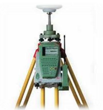
شکل (۲-۳۲): یک نمونه آنتن مرجع سامانه موقعیت با دو فرکانس
