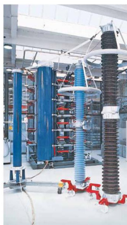
شکل (۲-۵۹): برقگیر با هوزینگ چینی (جلو) و هوزینگ پلیمری (عقب) در آزمایشگاه
