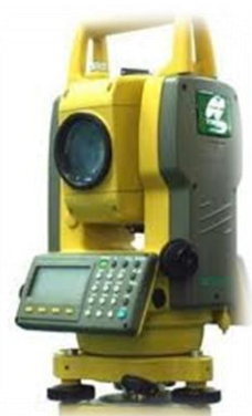
شکل (۲-۳۱): یک نمونه دوربین Total Station با قابلیت ثبت و ذخیره اطلاعات
