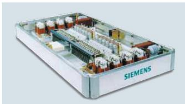
شکل (۲-۶۷): شمای ظاهری ماژول ولو شرکت زیمنس با تریستور نوری
