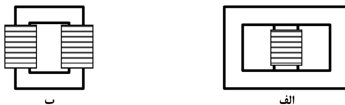
شکل (۲-۵۰): انواع ترانسفورماتور الف- shell form- ب- core form
