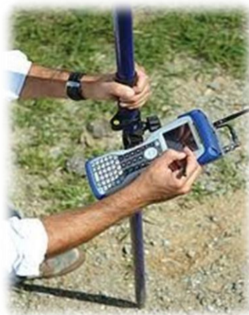
شکل (۲-۳۳): راهنما یا Navigator دستی که با آنتن مرجع کار
