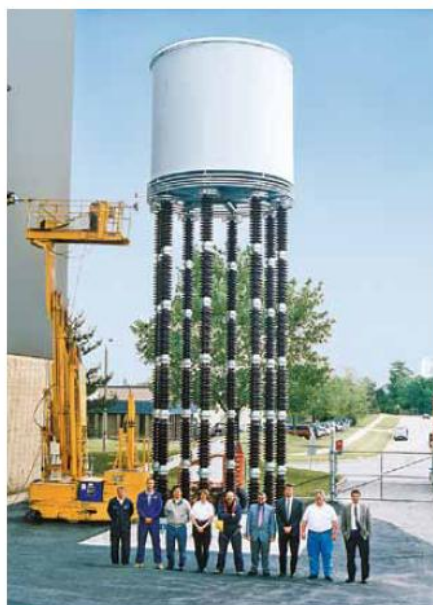
شکل (۲-۷۹): راکتور صافی خشک با هسته هوایی در پروژه Tian Guang کشور چین
